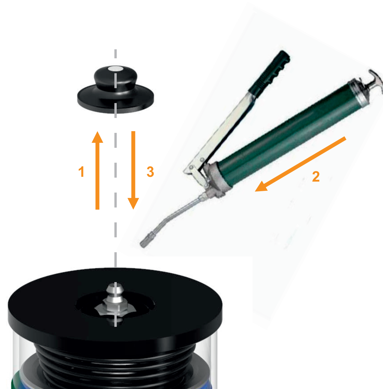
Рис. 5.1 Процесс дозаправки смазки
