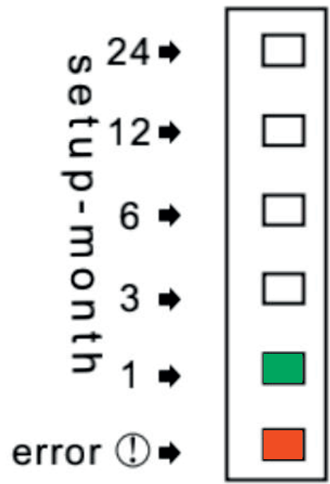
Рис. 9.1 Не обнаружен моторный импульс (батарея почти разряжена)
