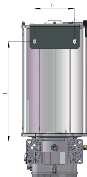
Рис. 19.3 Монтажные размеры насоса ALPB (тип с мешалкой и пружинным поршнем) – верхнее крепление для насосов 15 л, 20 л и 30 л.
