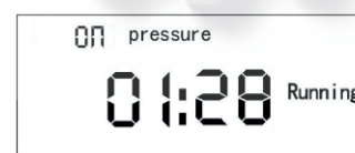
Рис. 24.3 Индикация прямого отсчёта времени смазки 3P
