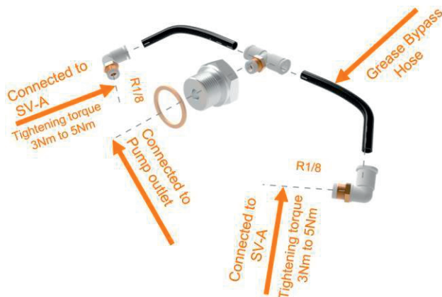
Рис. 18.6 Схема двойного байпаса
