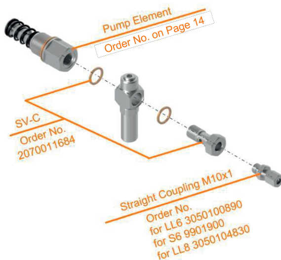
Рис. 16.2 SV-C с PE + Прямое соединение
