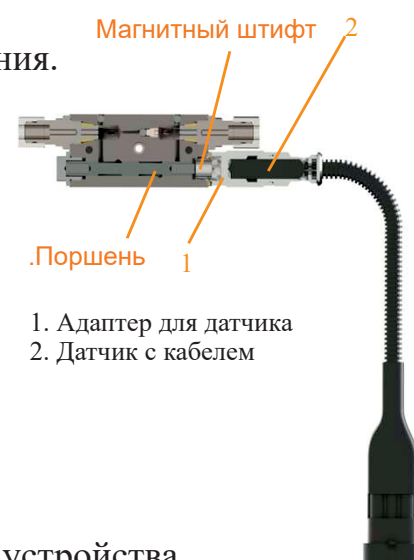
Рис. 10.1 Схема принципа присоединения датчика приближения к распределителю справа.
